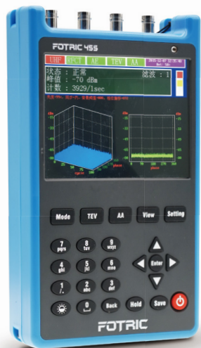
FOTRIC 455 高压局部放电巡检仪
