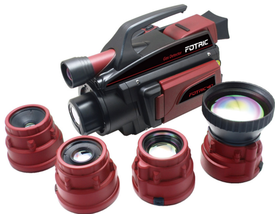
FOTRIC 467 OGI 适用于碳氢化合物泄漏检测
